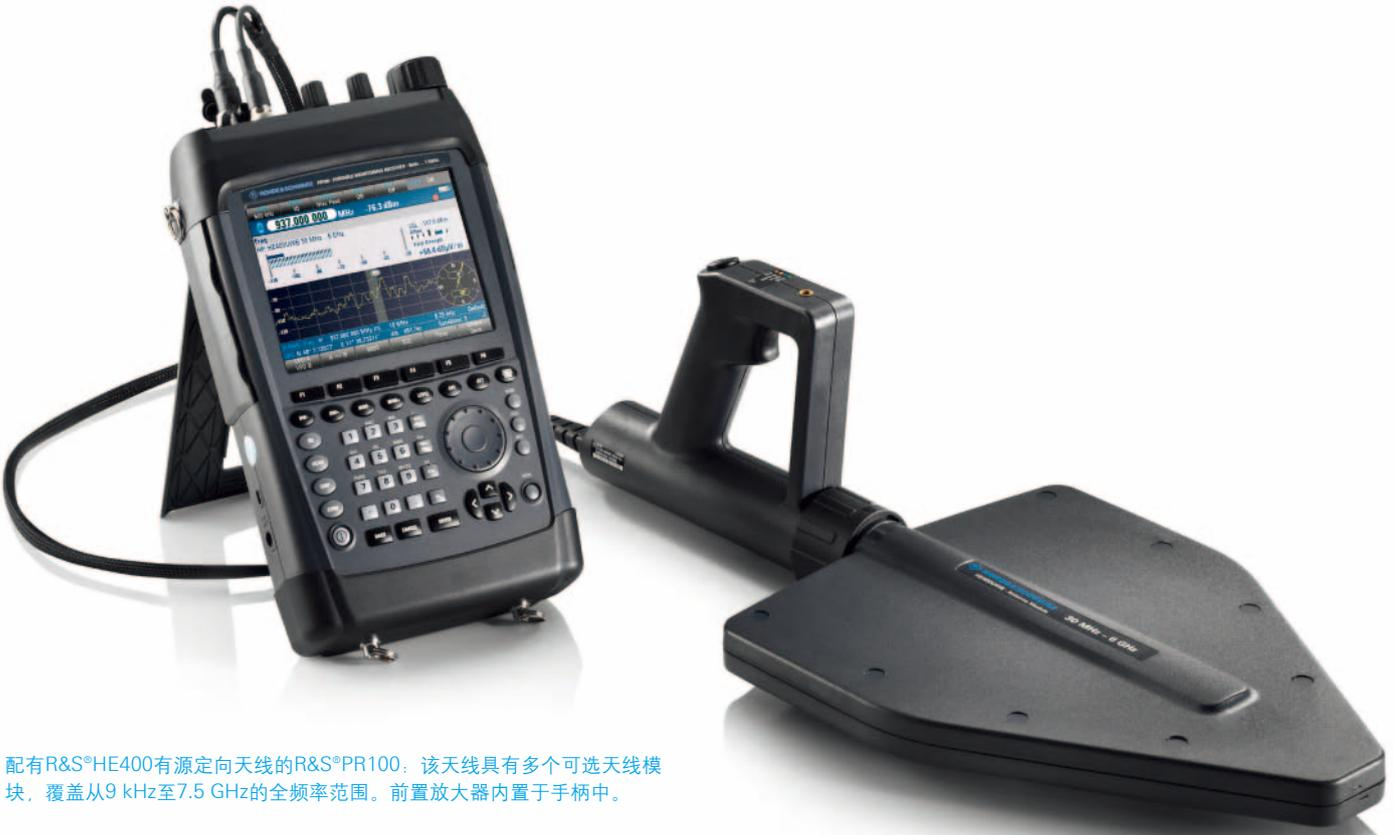
配有R&S®HE400有源定向天线的R&S®PR100：该天线具有多个可选天线模块，覆盖从9 kHz至7.5 GHz的全频率范围。前置放大器内置于手柄中。
