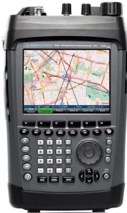
在地图上手动选择多个自动测向结果进行三角测量并显示交叠定位结果。
