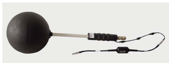
利用各向同性天线更容易完成辐射测量
