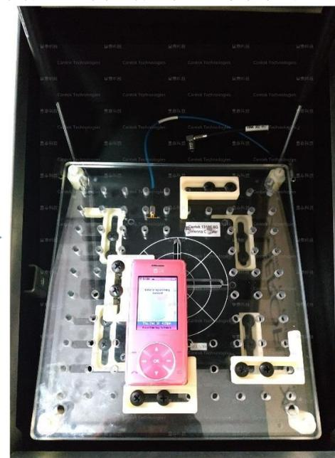
为被测设备定制XY双轴向可调的测试夹具（状态1、状态2、状态3：被测设备UUT是LG的CDMA制式手机）
